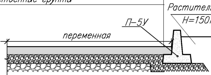
Закрепление бортовых камней П-5У
